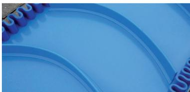
**KEIPER Maschenfilterbänder** werden aus stabilem monofilament Polyesterfaden, zu einem offenmaschigen Gewebe, gefertigt. Durch unterschiedliche Fadenanzahl und -durchmesser lässt sich die Maschenweite und die Durchlässigkeit des Gewebes auf die jeweilige Anforderung des Produkttransportes anpassen. Filtertransportbänder eignen sich besonders für Anwendungsbereiche zum fortlaufenden Filtern, abtropfen und trocknen der zu transportierenden Produkte.
